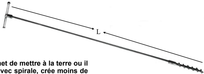
La tige de M.A.L.T. temporaire vissée permet de mettre à la terre ou il n'y a pas grille de M.A.L.T.. La tige de 6' avec spirale, crée moins de résistance qu'une tige droite. L'efficacité de la tige dépend toutefois des caractéristiques du sol. La tige est en cuivre et la spirale ainsi que la poignée, sont en bronze.
